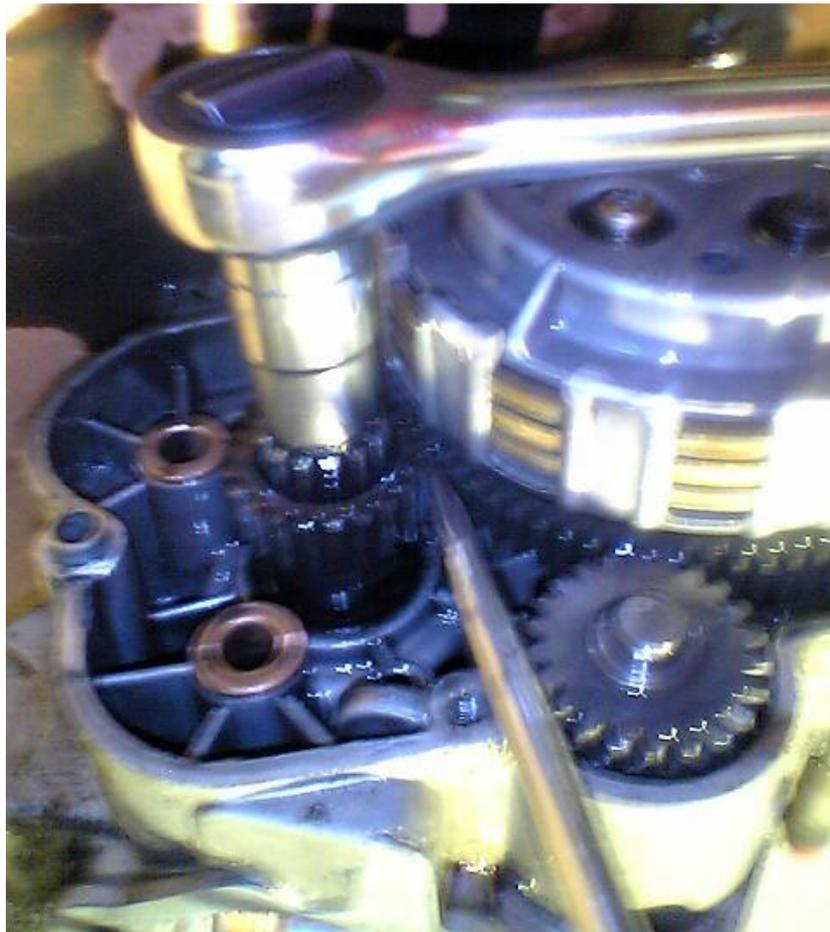
10. Nun wird das Primärrißel mithilfe des Klauenabziehers abgezogen. Alternativ kann eine Mutter auf den Stumpf der Kurbelwelle geschraubt werden und mit einigen Hammerschlägen die Kurbelwelle aus dem Primärrißel geschlagen werden. Diese Methode ist besonders bei der originalen Kurbelwelle nicht empfehlenswert, da das Gewinde meist Schaden nimmt und die Welle somit zerstört ist. Setzt den Klauenabzieher wie auf dem Foto ersichtlich an und zieht das Polrad von dem Kurbelwellenstumpf ab.
