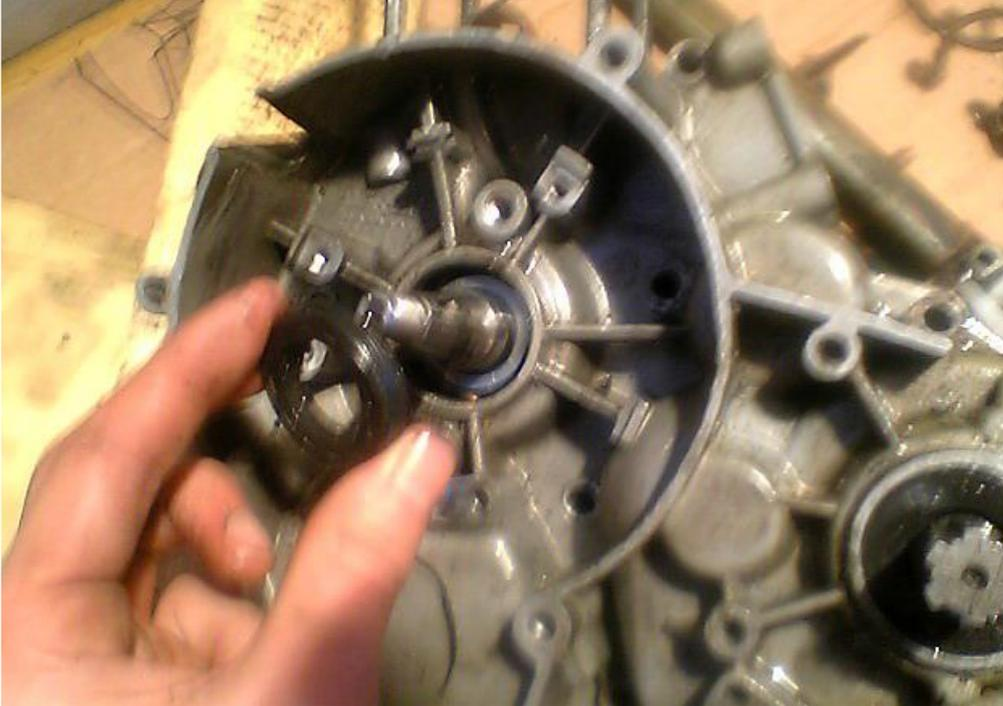
9. Im nächsten Schritt wird das Primärritzel an der Kupplungsseite demontiert. Dazu muss wieder ein stabiler Schlitzschraubendreher zwischen die Zahnflanken des Primärritzels und Kupplungskorbes gesteckt werden und gleichzeitig die Mutter wie unten abgebildet aufgeschraubt werden. Nun können die Antriebszahnräder für die Öl- und Wasserpumpe abgenommen werden.
