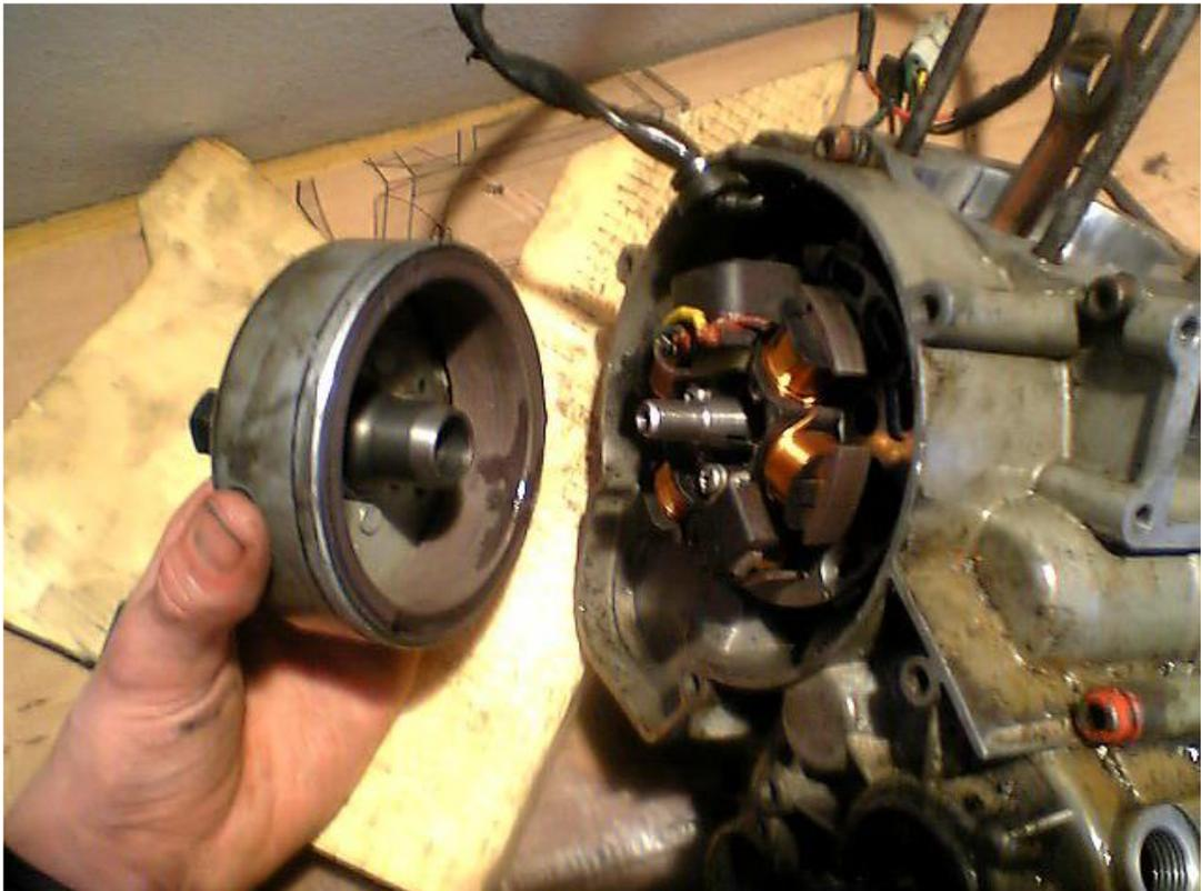
7. Nun können die Schrauben an der Zündspule abgenommen werden und die Zündspule demontiert werden. Auch die darunterliegende Grundplatte muss entfernt werden.
