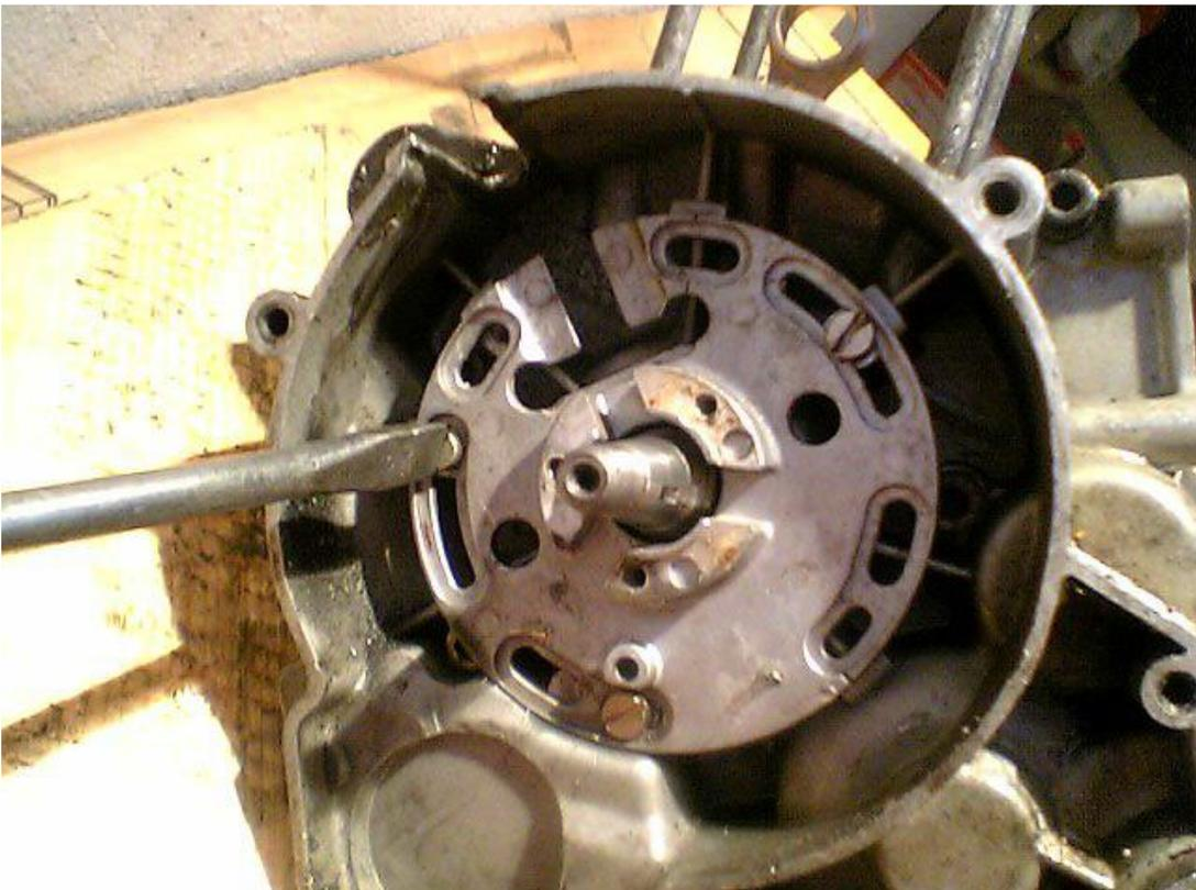
8. Jetzt kann der Simmering der linken Kurbelwellenseite entnommen werden. Dazu einfach mit einem Schlitzschraubendreher den Simmering heraushebeln.
