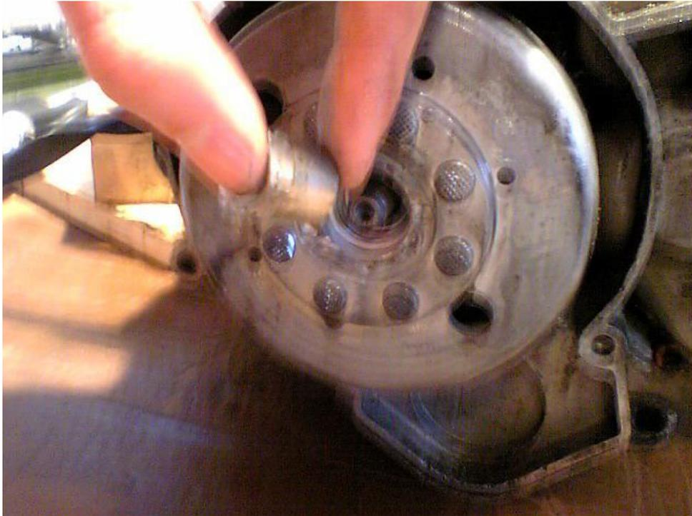
6. Nun muss das Polrad abgezogen werden. Dreht dazu den Polradabzieher in das Gewinde des Polrades und zieht dann die Schraube am Abzieher immer fester. Haltet den Abzieher dabei mit einem Gabel- oder Ringschlüssel und dreht die Schraube mit einer Ratsche immer weiter hinein, bis sich das Polrad löst.
